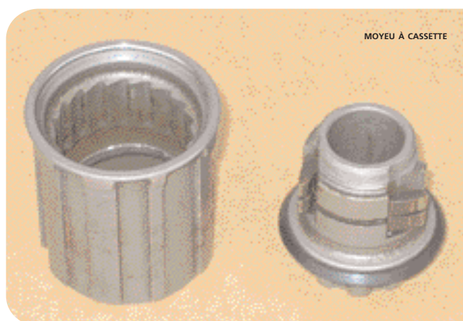
▲ Sur la partie gauche, la roue à rochets, sur la partie droite, les cliquets. ▼
