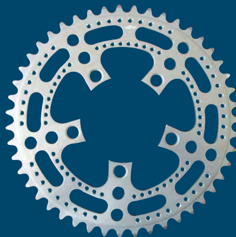
▲ Plateau Stronglight. Le diamètre de fixation est de 86 mm. Il permet de fixer tous les plateaux sur le même trou, le petit ayant 28 dents. C'est la solution 1.
