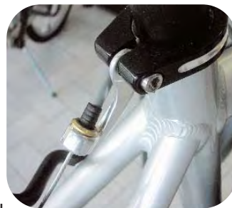
▼ Cantilever à tirage central. Réglage sur la butée de gaine.
