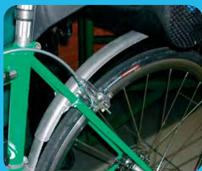
▲ Garde-boue "bricolé" dangereux et inefficace !
