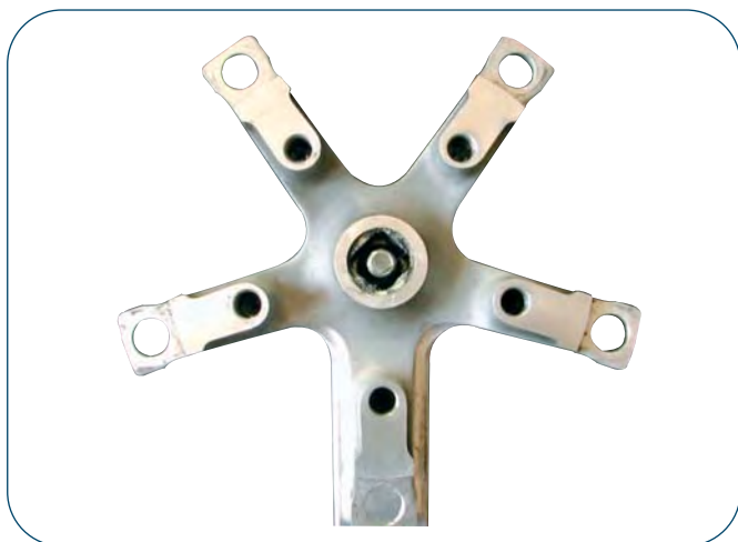
▲ Sur cette manivelle TA Alizé existent deux séries de trous. L'une à l'extérieur et de diamètre 130 mm pour les plateaux extérieurs et intermédiaire, l'autre de diamètre 74 mm pour le plateau intérieur. C'est la solution 2A !
