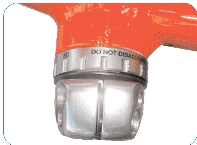
▲ Manivelle définitivement fixée, serrée sur l'axe. (La manivelle "fendue" est caractérisée Shimano).
