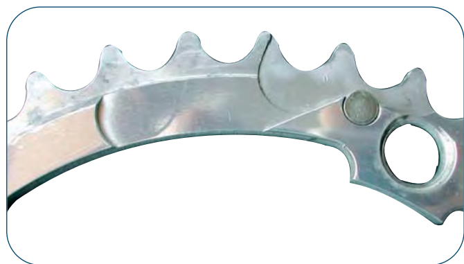
▲ Plateau intermédiaire TA sur lequel le chanfrein comporte une rampe de montée suivie d'un plot d'accrochage.
