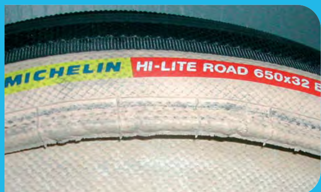
▲ Les tringles souples ne sont pas réservées aux petites sections. Voici un pneu Michelin de largeur 32 mm et diamètre 584 mm (650B). Il existe aussi des tringles souples sur les pneus VTT.
