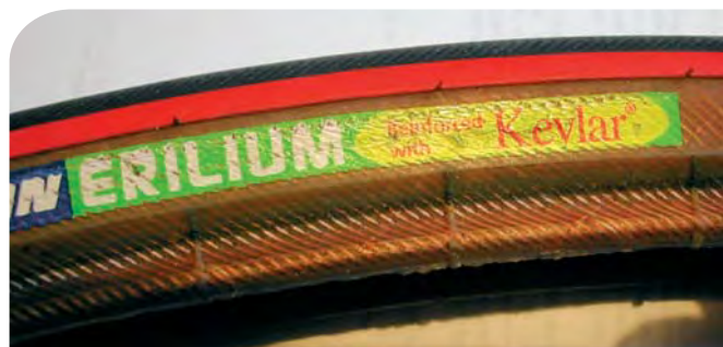
▲ Pneu Michelin Erilium (23x622) à bande anticrevaison incorporée dans la bande de roulement.
