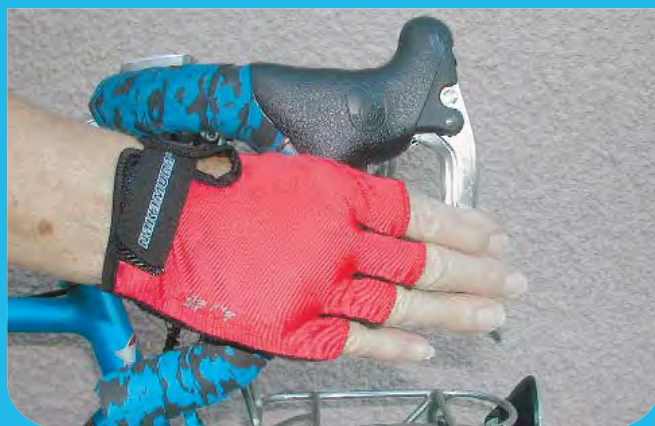
▼ Ici la distance cintre/poignée est réduite. Son utilisateur (trice) n'aura aucun mal à atteindre la poignée.
