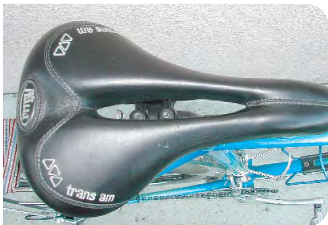
▲ Selle dame, évidée en son centre. Cette forme particulière est supposée éviter le point de compression du périnée. Pour être tout à fait efficace, son réglage doit être parfait, sinon le remède est pire que le mal !
