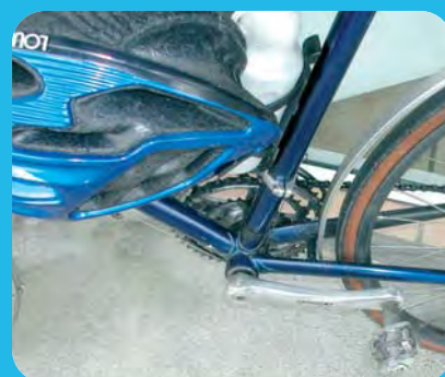
▲ Arrière long permettant de démonter facilement la roue.
