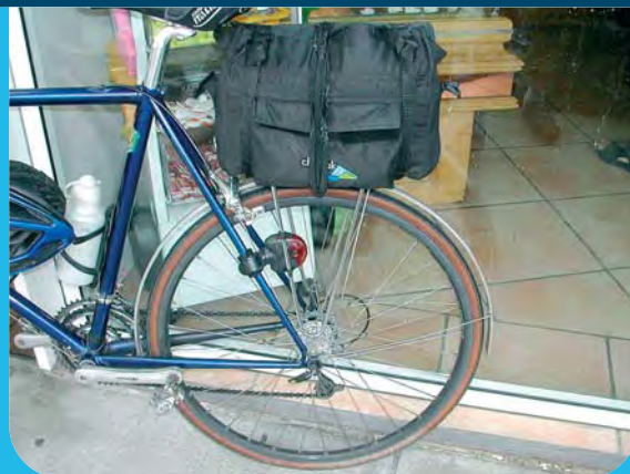
▲ L'arrière est assez long pour que le sac soit situé sur l'axe de la roue.
