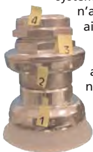
◀ Jeu fileté : 1. Cuvette inférieure. 2. Cuvette supérieure, les 2 cuvettes contiennent leurs roulements respectifs. 3. Bague d'appui, réglable. 4. Contre-écrou.
