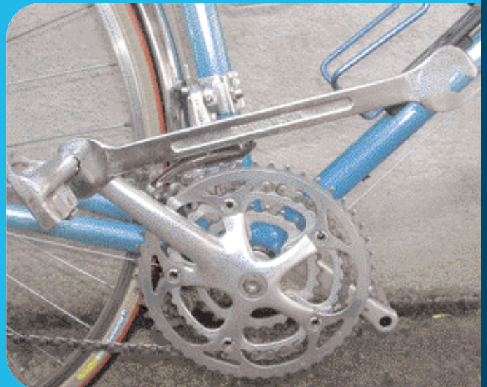
▲ Démontage de la pédale.
