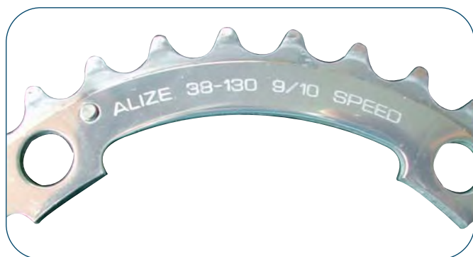
▲ Sur ce plateau TA Alizé pas de doutes : il s'agit d'un plateau de 38 dents, d'un diamètre de fixation de 130 mm pour une transmission 9 ou 10 vitesses.
