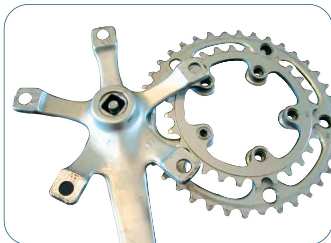
▲ Sur cette manivelle Stronglight, une seule série de trous de diamètre 130 mm qui recevra les plateaux extérieur et intermédiaire. Ce dernier comporte une deuxième série de trous de diamètre 74 mm qui recevra le plateau intérieur. C'est la solution 2B !
