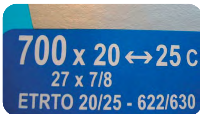
▲ Cette chambre est destinée aux pneus et jantes de diamètre 622 à 630 (ce dernier peu usité). Elle pourra être montée sur des pneus de section de 20 mm à 25 mm mais pas au-delà.
