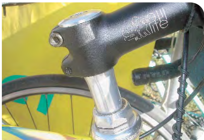
▲ Bonne combinaison ! Un plongeur réglable en hauteur et une potence Ahead-Set réversible !
