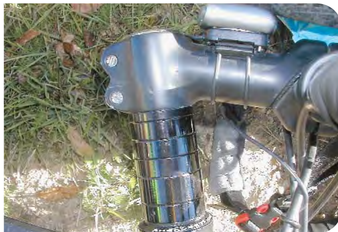
▼ Pas moins de 6 entretoises ont été nécessaires pour parvenir à la bonne hauteur ! Visiblement le cadre n'était pas "à la hauteur !".
