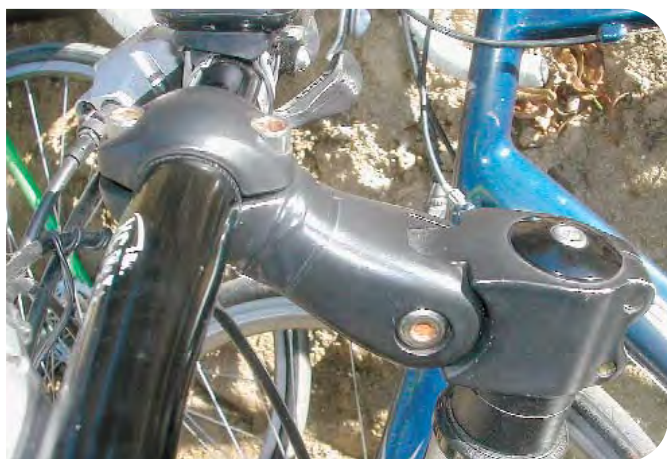
▲ Ici la potence est articulée permettant un réglage "à la demande !".
